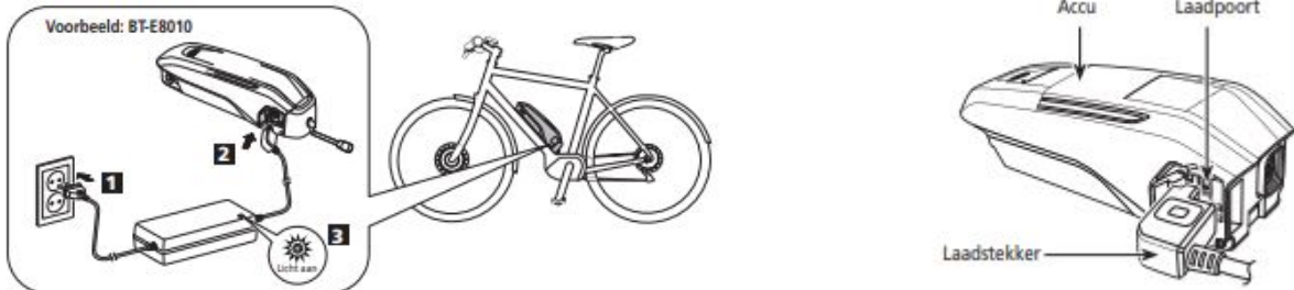
Figuur 3. Accu opladen op de fiets en detailoverzicht stekker
